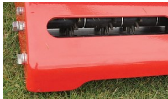
Uusi puhdistusmekanismi jyrärullille
